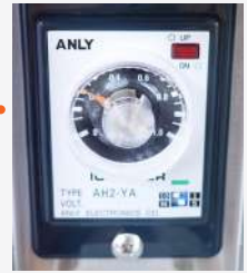
洗瓶時間旋鈕 Rinsing time knob
