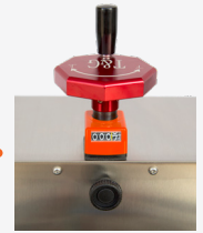
鎖蓋高度調整手輪 & 位置顯示器 Capping height adjusting device & Position indicator
