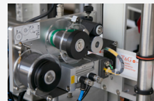
熱燙印字機 & 可調支撐座 (選配項目) Hot stamping printer & Adjustable rack (optional item)
