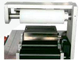
自動感應啟動電眼 & 快速調整扶瓶滾輪座 Labeling start-up sensor & Quick-changeover bottle holder
