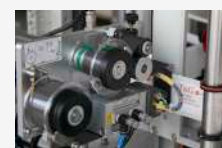
熱燙印字機 & 可調支撐座 (選配項目) Hot stamping printer & Adjustable rack (optional item)
