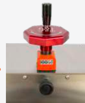
鎖蓋高度調整手輪 & 位置顯示器 Capping height adjusting device & Position indicator
