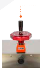
便利調整手輪 & 位置顯示器 Up / Down adjusting device & Position indicator
