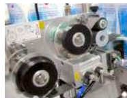
熱燙印字機 & 可調支撐座 (選配) Hot stamping printer & Adjustable support rack (optional item)
