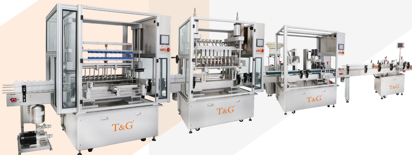
洗瓶機 Rinsing → 充填機 Filling → 鎖蓋機 Capping → 貼標機 Labeling
