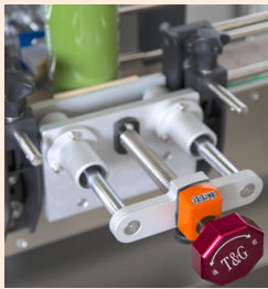
便利調整手輪 & 位置顯示器 Front / Back adjusting device & Position indicator
