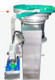
自動下蓋系統 Automatic cap feeding system
