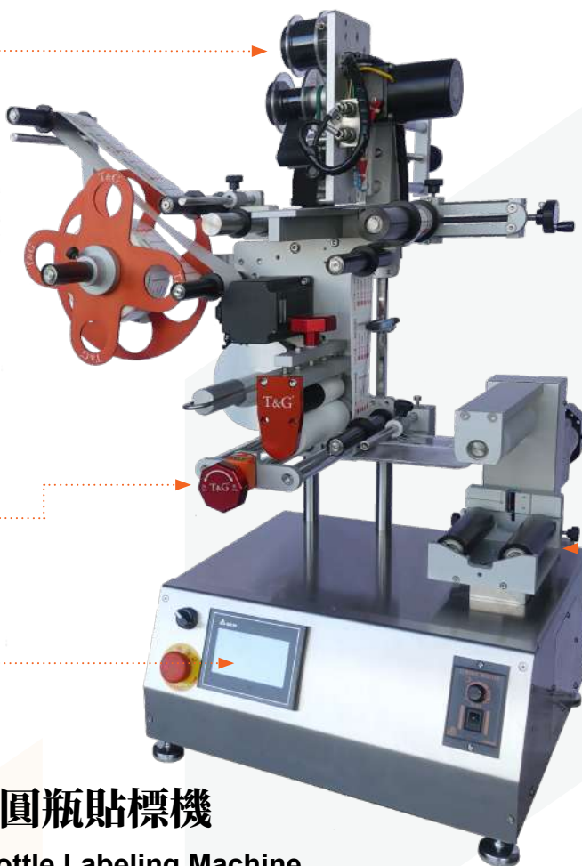
便利調整手輪 & 位置顯示器 Convenient position adjusting device & Position indicator
