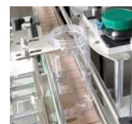
自動分瓶裝置 Automatic bottle dividing device
