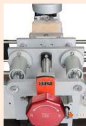
便利調整手輪 & 位置顯示器 Front / Back adjusting device & Position indicator
